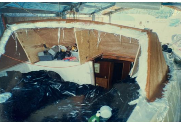
Damit der Polyester am Holz nicht klebt, wird dieses vorher mit einer dicken Schicht Trennwachs bestrichen.
